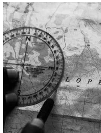
Figure 6.8: utilisations d'un rapporteur et d'une boussole pour calculer un cap.
