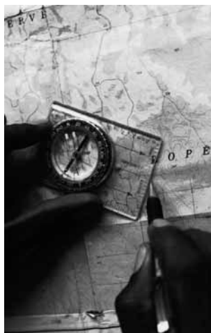
Figure 6.8: utilisations d'un rapporteur et d'une boussole pour calculer un cap.
